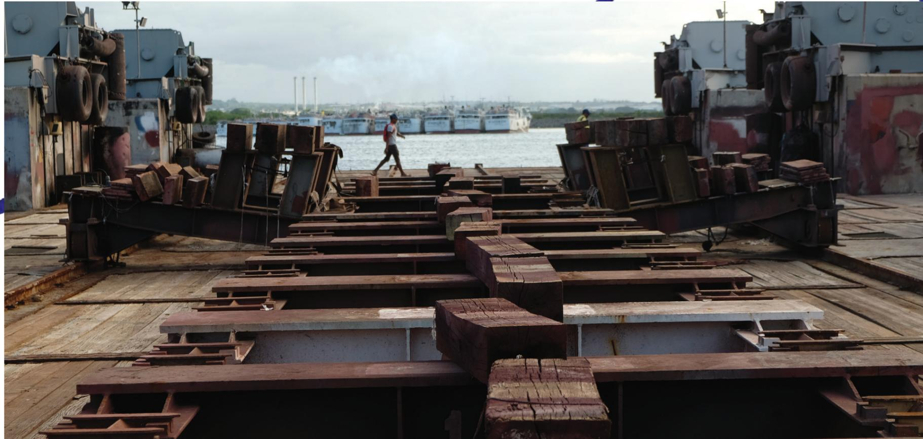
La ligne de tins, deuxième moyen de mise à sec du chantier, bientôt remplacée par un nouvel élévateur à bateau.
