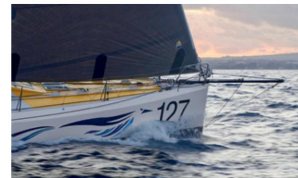
Le Class40 est un voilier monocoque de 12,19 m de long et 4,50 m de largeur maximale. La structure et technologie du bateau permettent la croisière rapide au large, pour les amateurs et professionnels.
